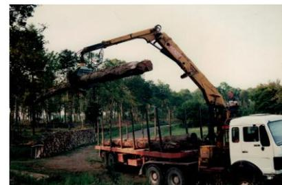
moteur du camion. On déchargeait tout d'un coup : d'abord, on ceinturait les troncs avec un câble, on le tendait puis on soulevait tout le paquet. Et ça tombait. Parfois le câble se décrochait ou cassait. Alors il fallait une heure pour tout dégager. Par la suite, on a utilisé une grue.
